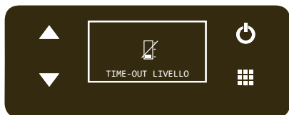
ALARMIERUNG TIME-OUT BEI KARBONATORFÜLLUNG
