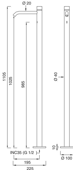
Portata aeratore 5 l/min / 1.3 gpm, risparmio idrico
