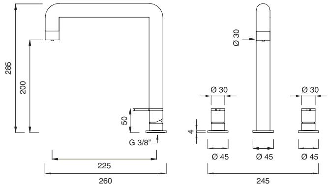
Portata aeratore 7 l/min / 1.8 gpm, risparmio idrico
