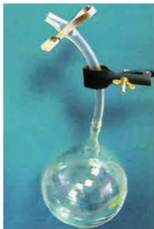
Рис. 127. Шар для взвешивания воздуха
