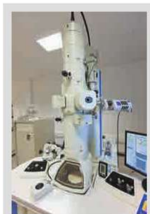
Электронный микроскоп позволяет получать изображения с увеличением до 10^6 раз
