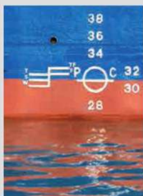
Отметки, определяющие грузовые ватерлинии судна при его загрузке в различных зонах, районах и в сезонные периоды плавания
