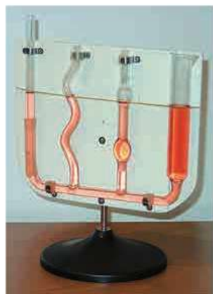
Рис. 121. Прибор, демонстрирующий установление одинакового уровня жидкости в сообщающихся сосудах
