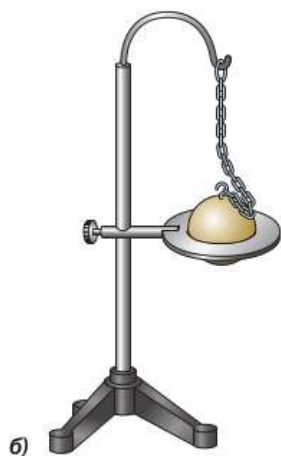
Рис. 21. Тепловое расширение металлического шара
