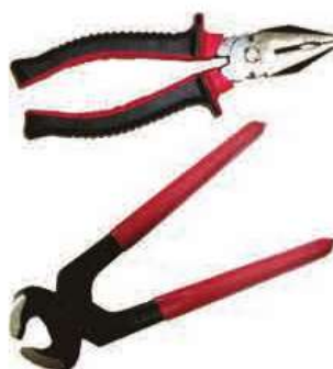
Рис. 95. Уменьшение площади режущей поверхности увеличивает давление на зажатое тело
